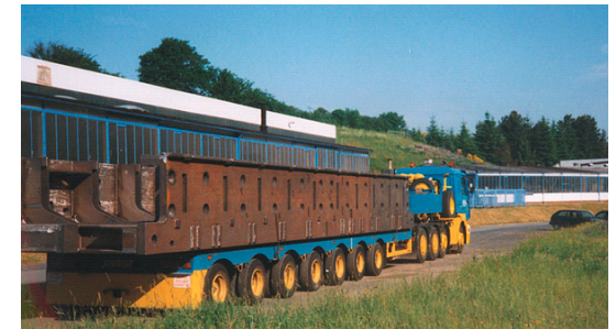
Abtransport einer Traverse (L: 15 m, B: 2,6 m, H: 1,8 m, G: ca. 76 t)
