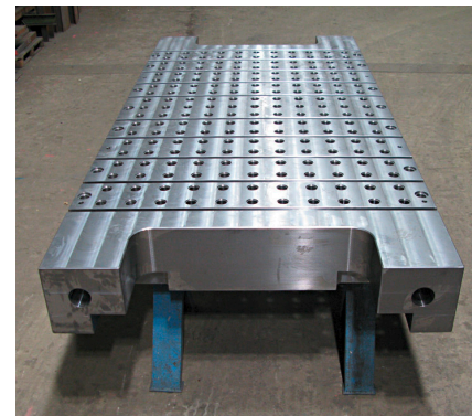
Tischplatte für 800 t-Hydraulikpresse (L: 4,5 m, B: 2,3 m, H: 0,4 m, G: ca. 30 t)
