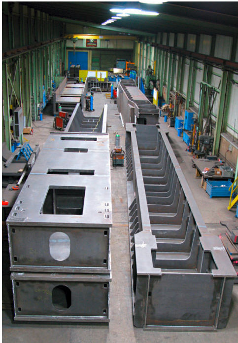
JUNG-Produktionshalle: Diverse Traversen (L: 15 - 20 m, G: ca. 50 - 75 t)
