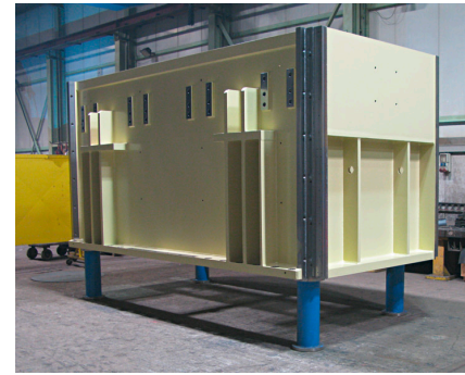
Pressen-Stößel für 1.000 t-Doppelständerpresse (L: 5,5 m, B: 2,9 m, H: 2,7 m, G: ca. 56 t)
