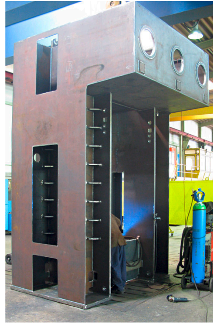
Maschinenständer (L: 6,8 m, B: 4,2 m, H: 3,5 m, G: ca. 48 t)
