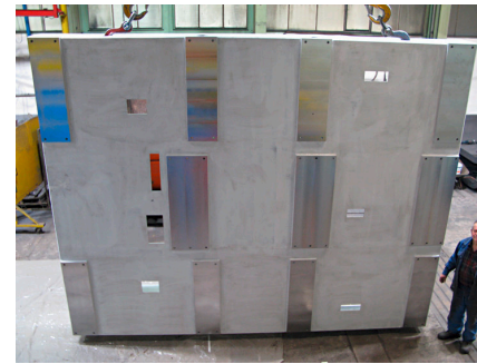
Extruder-Rahmen (L: 4,8 m, B: 3,8 m, H: 0,5 m, G: ca. 9 t)
